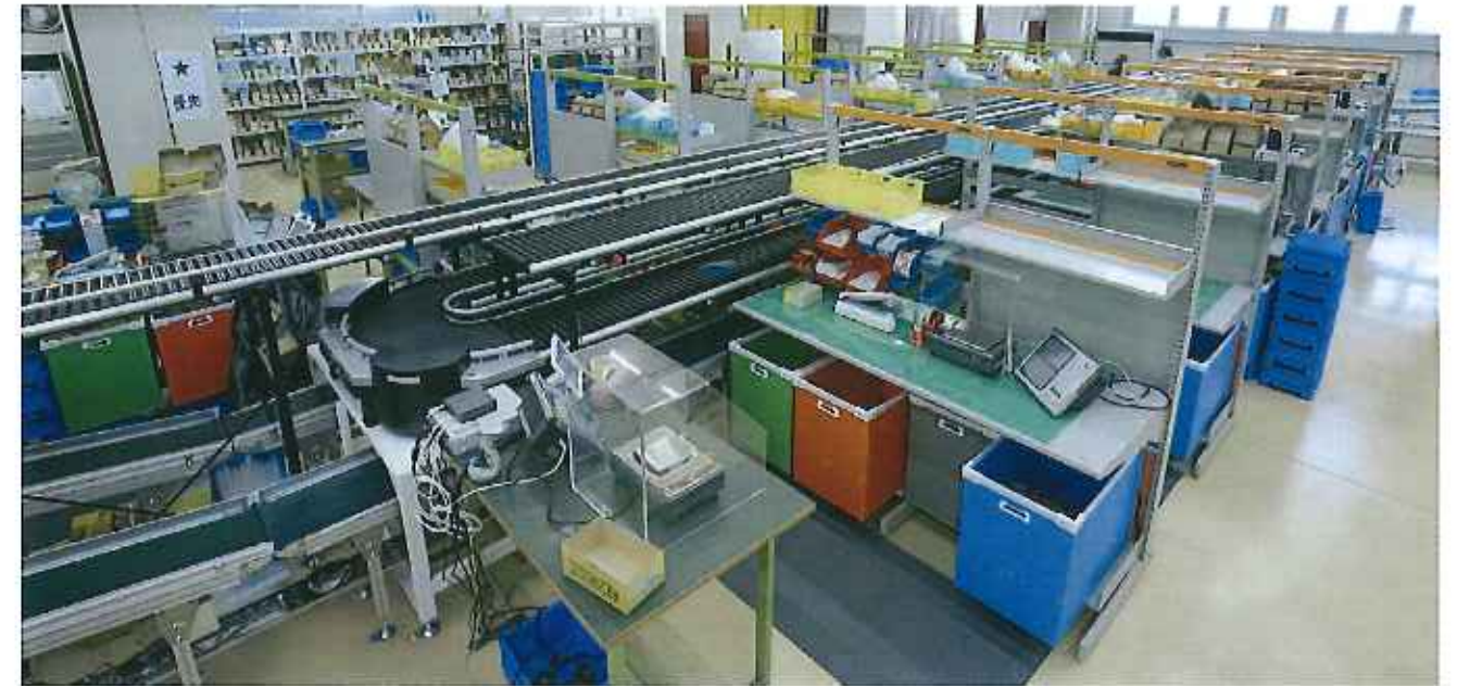
バラ品ピッキング・梱包ライン （3段コンベヤ：＜上段＞小箱再入庫ライン、＜中段＞バラピッキング待合ループライン、＜下段＞出荷商品搬送ライン）
